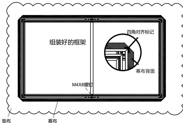
4.4 用拉簧将幕布钩挂在边框上。钩挂拉簧请遵照以下顺序，先按1~8的顺序装四个角的弹簧；然后再挂中间的弹簧9~12，再从中间弹簧出发，依次对称向两边挂装其他的弹簧。拉簧安装方法请参见附图。
