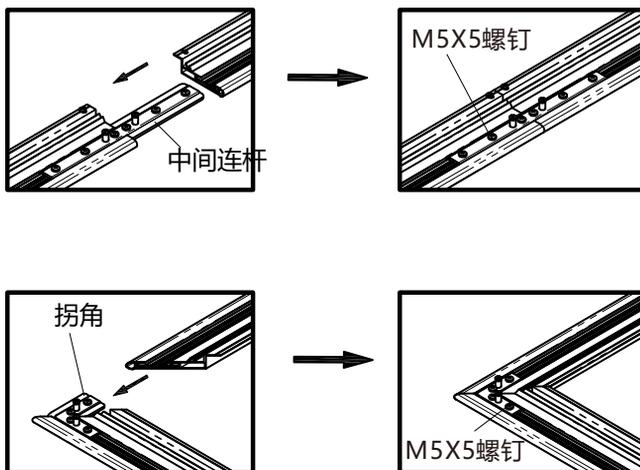
3.3 先将4个拐角插入竖向内框中，如图1;如果是拼接的边框，需用中间连杆将两段边框连接起来,如图2。
